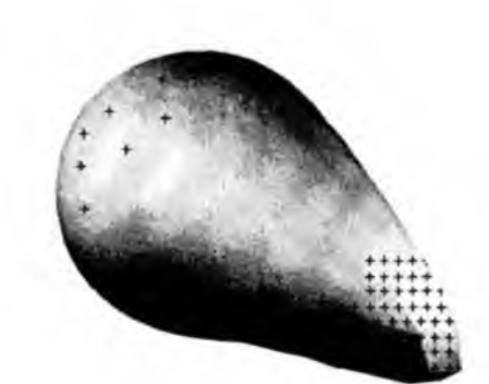
Fig 4.15 Distribución de carga en un conductor aislado con diferentes radios de curvatura
