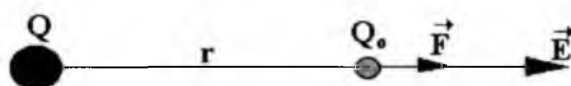
Fig. 2.1 La dirección del campo eléctrico es la misma de la fuerza electrostática.
